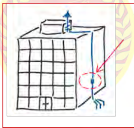
Foto nr. 68. Vendi për matjen e përcueshmërisë së elektricitetit
