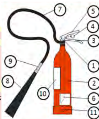
Слика бр. 36. ПП-апарат од типот „CO 2 “ - 5 kg
