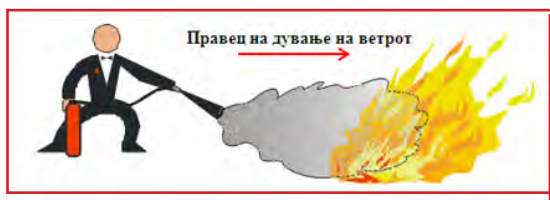
Слика бр. 37. Гаснење со ПП-апарат од типот „CO 2 “-5 kg
