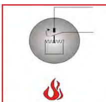
Слика бр. 57. Термодиференцијален јавувач со пневматски систем
