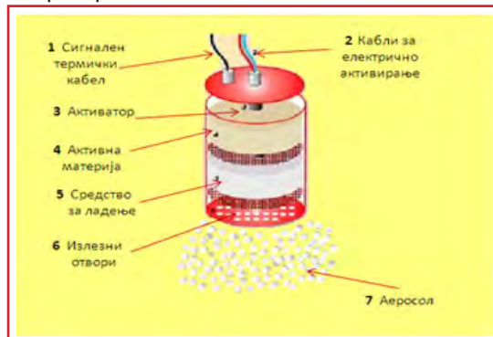
Слика бр. 63. Состав на аеросолен генератор
